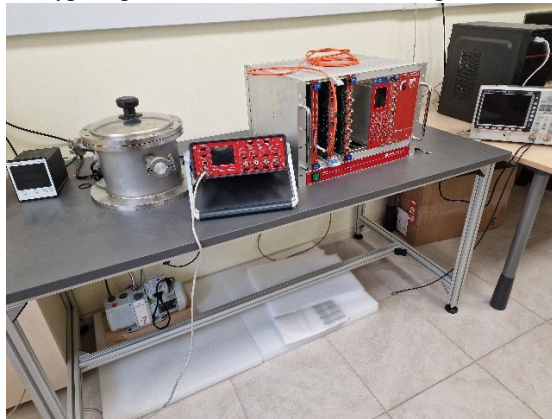
Фигура 8: Стенд за разработване и тестване под вакуум на детектори за заредени частици и прилежащата електроника за спектрометрични измервания.
