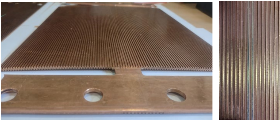
Фигура 6: Фрезовани широкоплощни медни плочи
