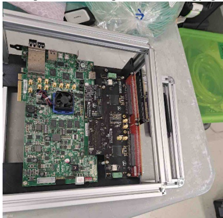
Фигура 7: FPGA базирана специализирана платформа за четене на данните от силициеви фотоумножители с H2GCROC3 чип
