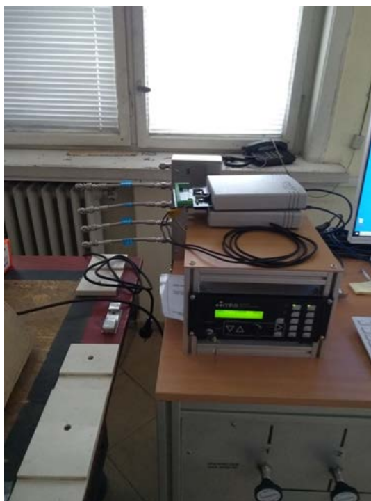
Фиг. 3 Електроника на сензорите на газовият стенд – 24 разряден АЦП и сензори за РТ100 на PICO technology и електронен модул на високочувствителен сензор “Baratron” MKS Instruments
