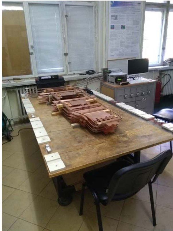
Фиг.7 Тест на 4 модула със заменени и изпитани при 15 атмосферни гъвкави връзки (50 см)
